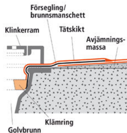
Golvbrunnen ska vara vågrätt monterad +/- 2 mm och enligt tillverkarens anvisning.
