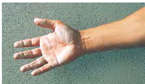
Underlaget skall vara rent och dammfritt.
