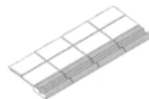
Bild 3 (bilderna ovan). Greppkantsplatta (där bassängkanten förses med greppkantsplatta ska denna ha en fördjupning eller förhöjning på 15 mm och färgmarkeras helt eller delvis).
