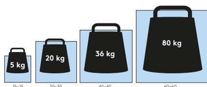
BILD 1. Bilden visar hur mycket tryck som behövs för att plattan ska pressas ned helt i rillorna vid normal läggning eller sättning i traditionell fästmassa för att uppnå fullgod bruksfyllnad.
