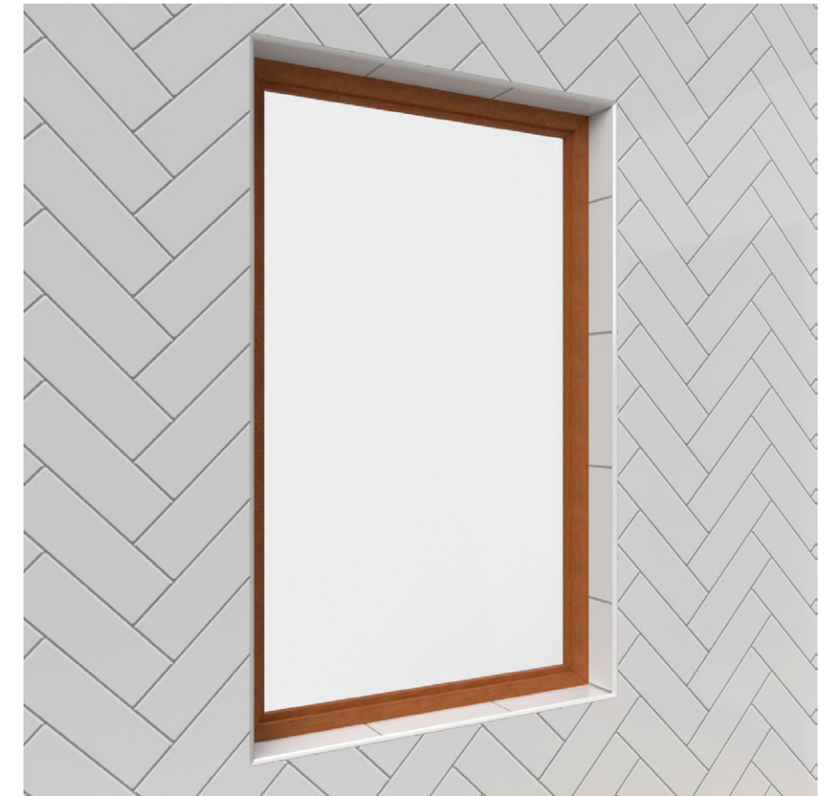
FIGUR 8. I figuren visas ett exempel på mönstersättning i form av fiskbensmönster med rak sättning i smygen.
