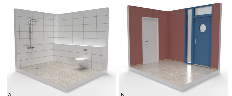
FIGUR 1 A–B. Normalt sätts keramiken vågrätt/lodrätt, om inget annat är avtalat. Ovan visas exempel på ett vått och torrt utrymme.
