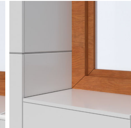
FIGUR 17 B. Smygens platta råder över väggens platta, på sidorna är det väggens platta som råder över smygens. Eventuell skuren kant ska dövas.
