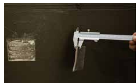
Mätning av utskuren tätmembran med elektroniskt skjutmått (2,82 mm).
