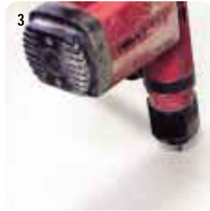
3 Är golvet ojämnt: borra, plugga och skruva så att full kontakt uppnås med underlaget.
