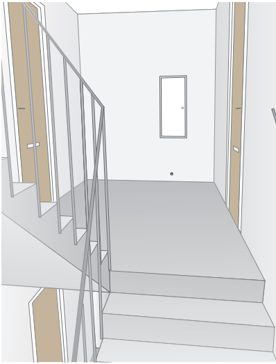
4.1i Läckageindikering som mynnar i trapphus.
