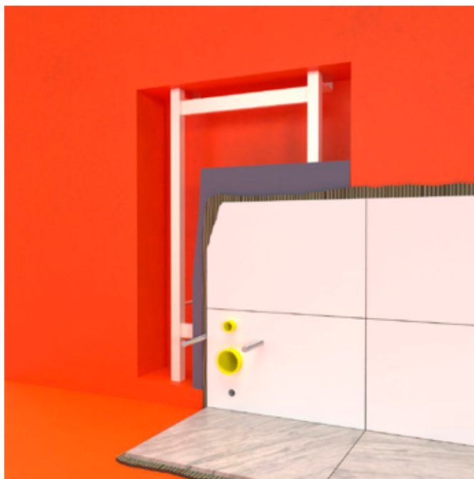
FIGUR 23. Tätskikt bakom inbyggd WC i vägg
