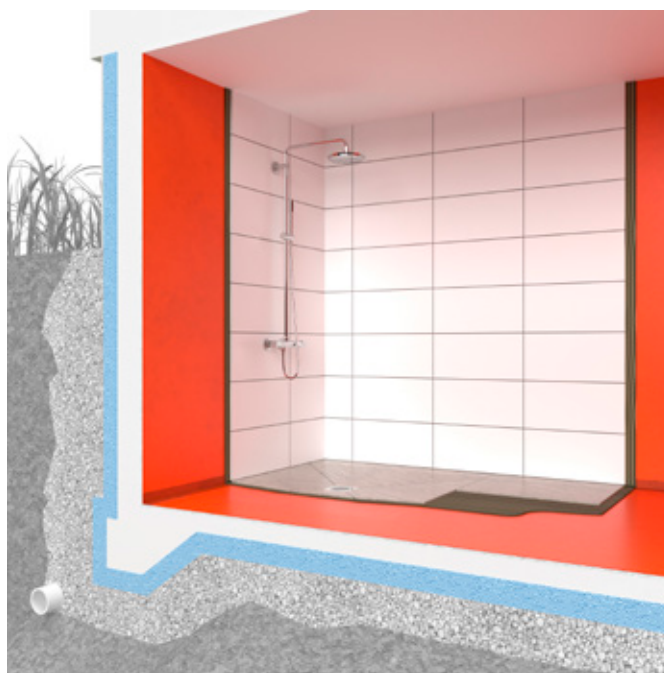
FIGUR 3. Källare utan tillskjutande markfukt
