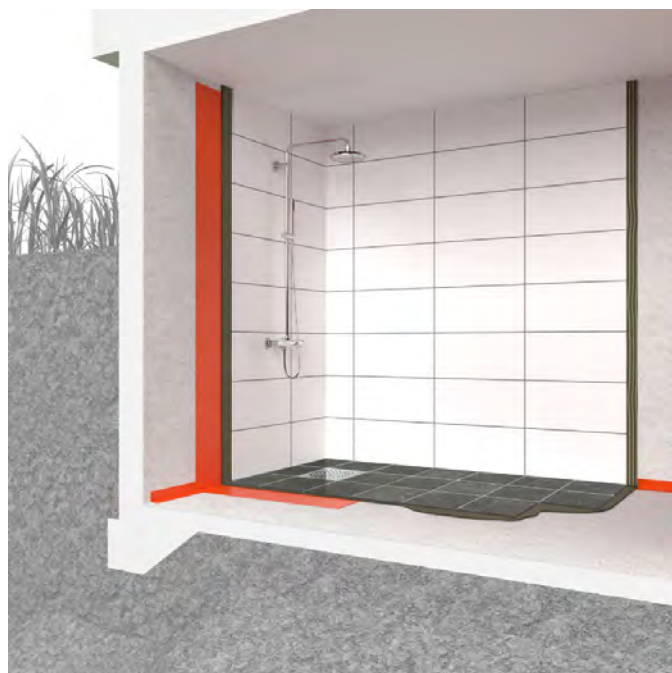
FIGUR 2. Källare med tillskjutande markfukt
