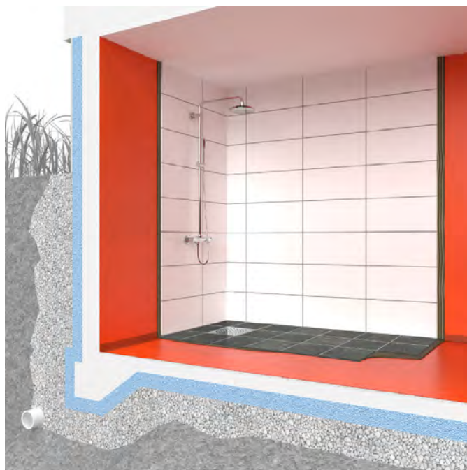
FIGUR 3. Källare utan tillskjutande markfukt
