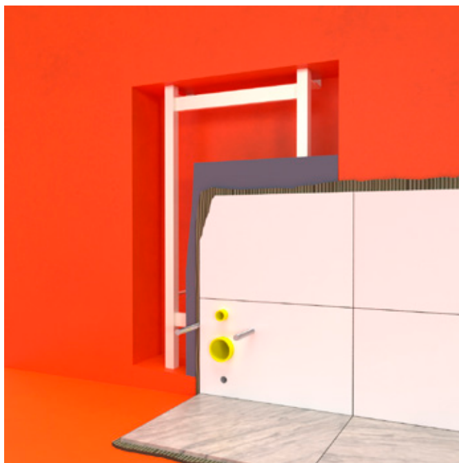
FIGUR 23. Tätskikt bakom inbyggd WC i vägg
