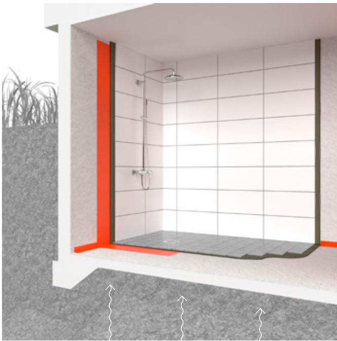
FIGUR 2. Källare med tillskjutande markfukt
